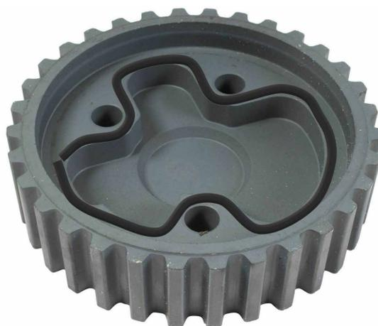
Sellante de silicona **Ajusil** en la parte trasera de la polea de la bomba de inyección.
