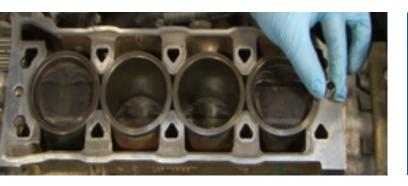
No girar el cigüeñal una vez retirados los útiles de sujeción de las camisas.
